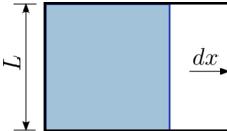
Figura 4: Film di sapone retto da un frame. Il lato destro del frame è mobile ed è tenuto in equilibrio da una forza 2F .
