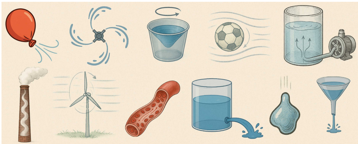
Figura 3: 11 esempi di non applicabilità dell'equazione di Bernoulli ristretta: un palloncino che si sta sgonfiando, un irrigatore rotante, un secchio rotante, un pallone rototraslante in aria, un contenitore d'acqua riempito dal basso, un flusso di vapore in una ciminiera, del vento che alimenta una pala eolica, un'arteria, un contenitore che si sta svuotando tramite un foro, una massa d'acqua in caduta libera e un imbuto che si sta svuotando.
